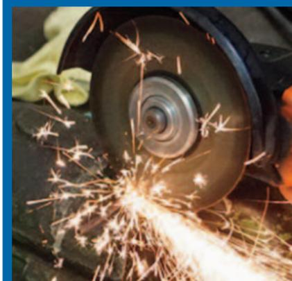
Löst sich das alte Drahtseil nicht, wird es mit der Flex von der Verpressung abgetrennt
