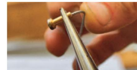
An dieser Stelle muss kontrolliert werden, ob das Verlöten fachgerecht durchgeführt wurde. – Bruchgefahr: Hier ist das Lötzinn beim Verlöten zu weit in den Draht aufgestiegen und versteift ihn
