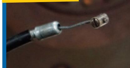
Schraubnippel sind nur an Zügen sinnvoll, die wenig betätigt werden, wie dieser Chokezug
