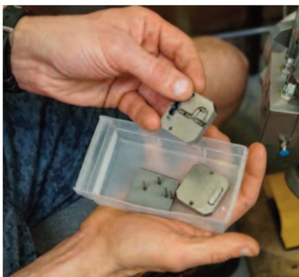
Für jede Nippelform braucht es spezielle Gussformen, die in Handarbeit hergestellt werden müssen. Auf Kundenwunsch werden auch Nippel in Sondergrößen an der Drehbank hergestellt
