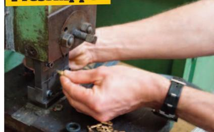
Jochen Reuter hat eine spezielle Maschine, mit der die Pressnippel mit dem Draht verpresst werden
