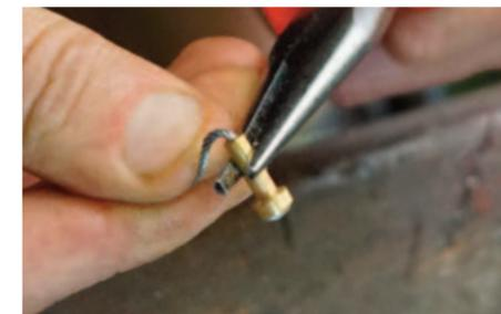
Lässt sich der Draht direkt hinter dem Nippel abbiegen, ist alles gut gegangen
