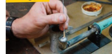
Das aufgespleißte Ende des Drahtes muss im Löttrichter des Löt-nippels vollständig verschwinden. Nachdem der Draht mit Lötlot getränkt wurde, „saugt“ er von selbst das flüssige Lötzinn an
