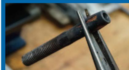
Die Verpressung der Gewindestange hat jetzt wieder den Durchmesser des Seils und kann wiederverwendet werden
