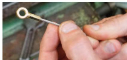
Von vier Seiten gleichzeitig ist der Pressnippel mit dem Seil verpresst worden
