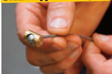
Die Kugel des eigens hergestellten Zinkdruckguss-Nippels muss völlig plan mit dem Zylinder des „Sondernippels“ sein
