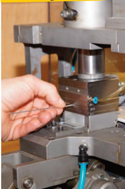
Die ARC Reuter GmbH hat eine Zinkdruckguss-Maschine, um Zugseile mit Gussnippel herzustellen. Das Drahtseil wird in die Form gelegt und flüssiges Zink unter hohem Druck in die Form gepresst
