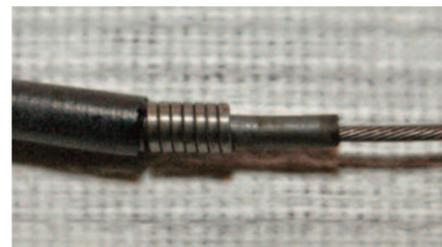
Der Schnitt zeigt deutlich, wie ein moderner Bowdenzug aufgebaut ist
