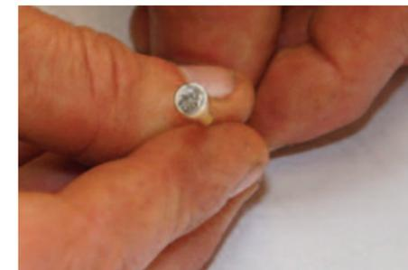
Löt-nippel-Trichter und aufgespleißter Draht bilden mit dem Lötzinn eine feste Verbindung
