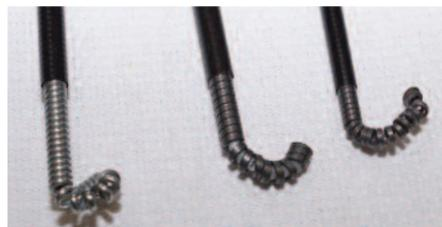
Links: Runddraht-Hülle; Mitte: Flachdrahthülle, innenliegendes Gleitrohr; rechts: konventionelle Flachdrahthülle
