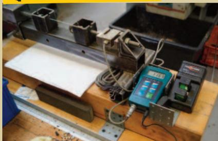
Qualitätskontrolle! In dieser Vorrichtung testet Jochen Reuter die Qualität seiner Verlötnungen. Bei knapp 117 Kilogramm Zug hält der Lötnippel immer noch
