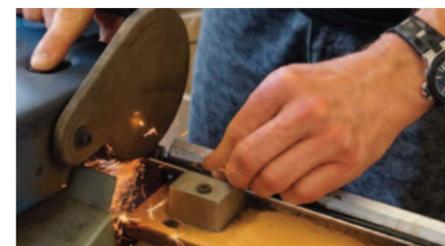
Das Ablängen der Bowdenzughüllen erfolgt mit einer speziellen Maschine, um Grate zu vermeiden
