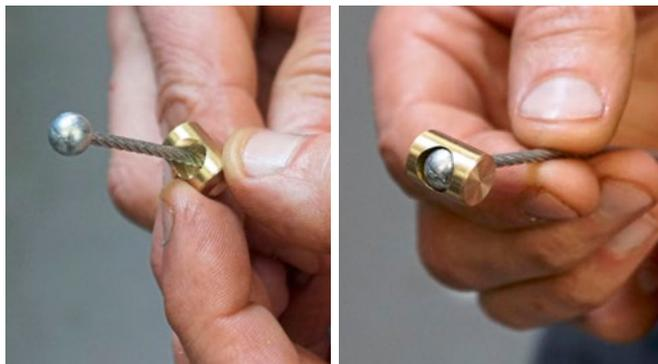
Verpressung vorzunehmen. Jochen Reuter hat die entsprechenden Zangen zum Verpressen im Angebot und rät, bei deren Anwendung darauf zu achten, dass die Verpressung ein möglichst langes Stück des Seiles überdeckt.
