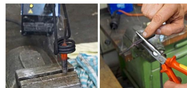
Gibt es für alte Pressnippel (hier: Gewindestange) keinen Ersatz, werden diese wieder aufgearbeitet. Nach dem induktiven Erhitzen (ganz links) ist das Drahtseil so weich, dass es mit der Zange herausgezogen werden kann
