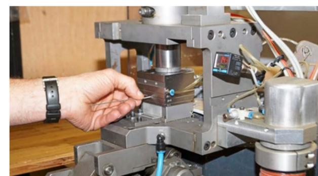
Jochen Reuter besitzt eine spezielle Zinkdruckguss-Maschine, um Zugseile mit Gussnippel herzustellen. Hierfür legt er das Drahtseil in die Form, in die anschließend flüssiges Zink unter hohem Druck gepresst wird
