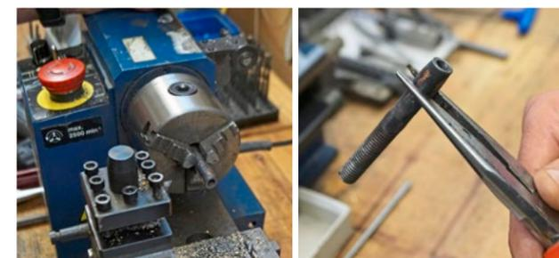
Löst sich das alte Drahtseil nicht, wird es mit der Flex von der Verpressung getrennt. Dann erfolgt das Ausbohren der Drahtreste auf der Drehbank (ganz links). Die Verpressung der Gewindestange ist nun mit einem neuen Drahtseil wiederverwendbar
