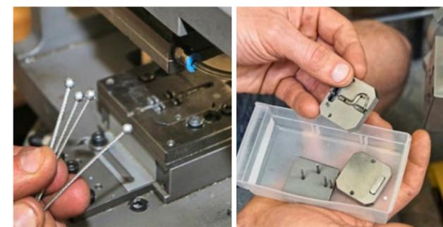
Ganz links: Bereits nach wenigen Sekunden ist das Metall erkaltet und die Nippel sind fertig. Für jede Nippel-Variante braucht es spezielle Gussformen, die in Handarbeit hergestellt werden
