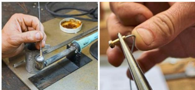
Kontrolle: In dieser Vorrichtung testet Jochen Reuter die Qualität seiner Verlötnungen. Bei diesem Zug haben die Löt-nippel bei knapp 117 Kilogramm immer noch gehalten
