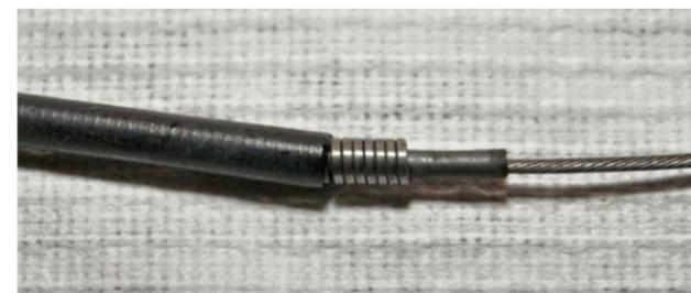
Hier erkennt man den Aufbau eines modernen Bowdenzugs mit einem inneren Gleitrohr zur Reibungsminderung, wie er bei Motorrädern seit über 30 Jahren gebräuchlich ist
