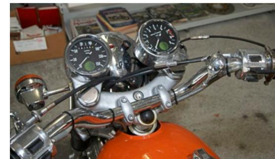
Der Biegeradius eines Bowdenzugs wirkt sich auf die Betätigungskräfte aus. Bei engen Radien steigen diese aufgrund innerer Reibung an, wodurch auch die Nippel stark belastet werden
